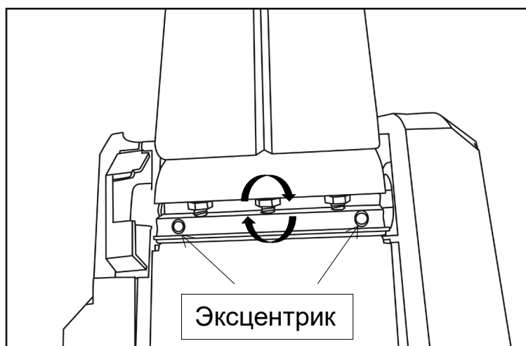
Рис.3. Замена режущего ножа
